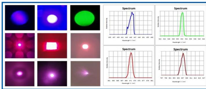
功率和波长稳定性：自然散热状态下功率和波长随温度变化而改变，当自热与环境平衡时达到稳定状态；通过TEC模块并精确控制核心器件的温度为设定值 $T \pm 0.1$ 范围，可使激光功率和波长最高在 $-30 \sim +70^\circ\text{C}$ 环境下连续工作时，始终保持稳定。
